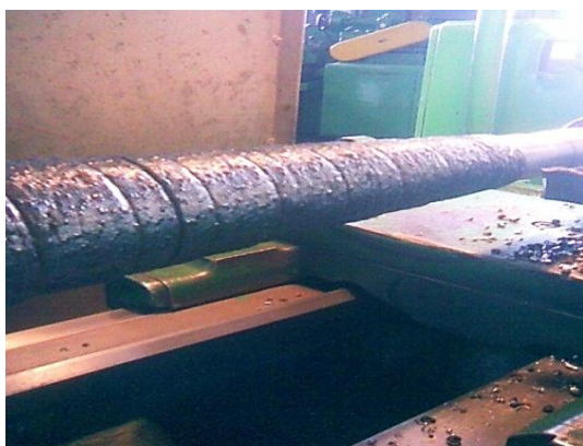
Рис. 5. Вид вала, наплавленного вибродуговой наплавкой
