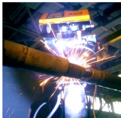
Рис. 4. Вибродуговая наплавка вала
